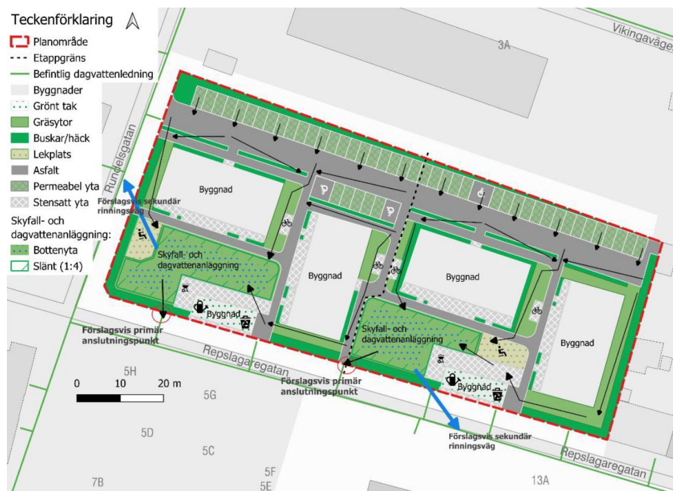
Figur 19. Illustration över föreslagen skyfalls- och dagvattenhantering. Bild: Sweco.
