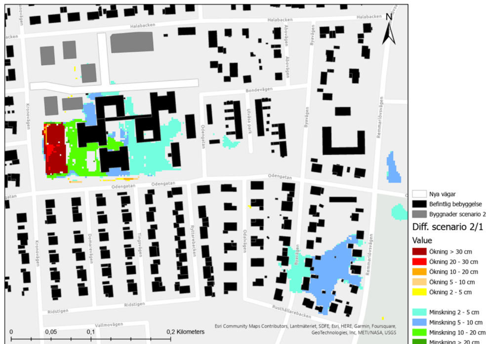
Figur 41. Skillnad i maximala vattennivåer om inga skyfallsåtgärder vidtas jämfört med om en fördröjningsyta på cirka 900 kubikmeter anläggs.
