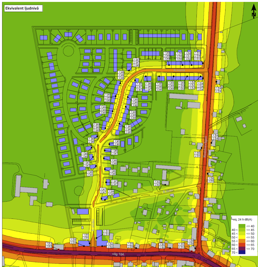
Figur 39. Beräknad ljudutbredning för ekvivalent ljudnivå 2 meter ovan mark och punktberäkning vid fasad för vägtrafik år 2040 enligt framtagna trafikutredning.
