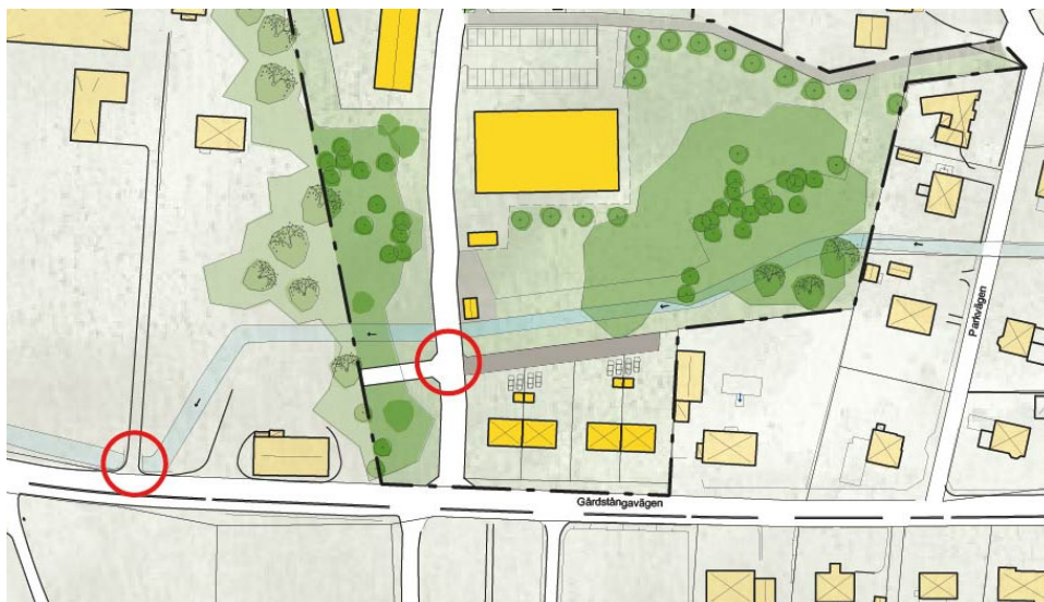
Figur 50. De två befintliga trummorna som behöver förstöras.
