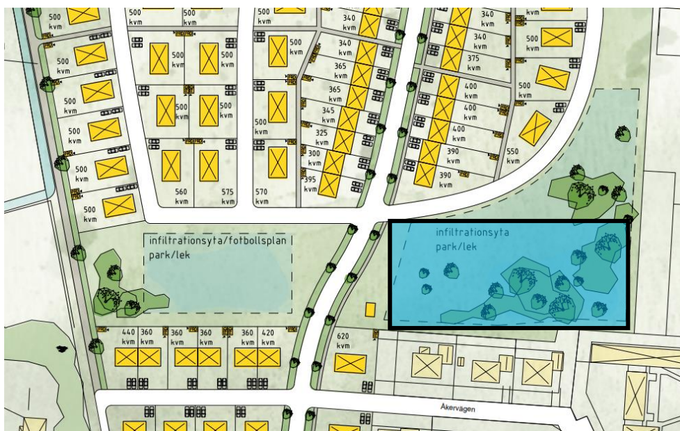
Figur 2. Illustration av yta med mått 50 x 105 m, vilken vid en nedsänkning med 0,6 m skulle kunna rymma erforderlig allmän dagvattenfördröjning på ca 2 900 m 3 .
