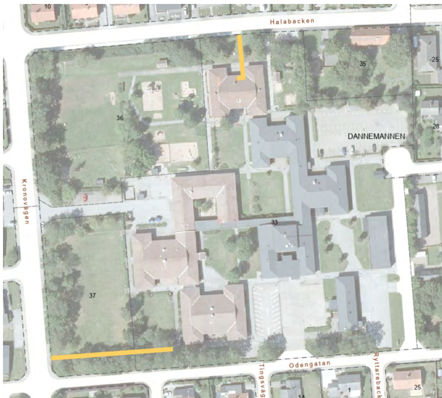
Figur 46. Sträckorna för aktuella ledningsrätter markerade i gult. Ledningsrätt för starkström i norr och för fjärrvärme i söder.
