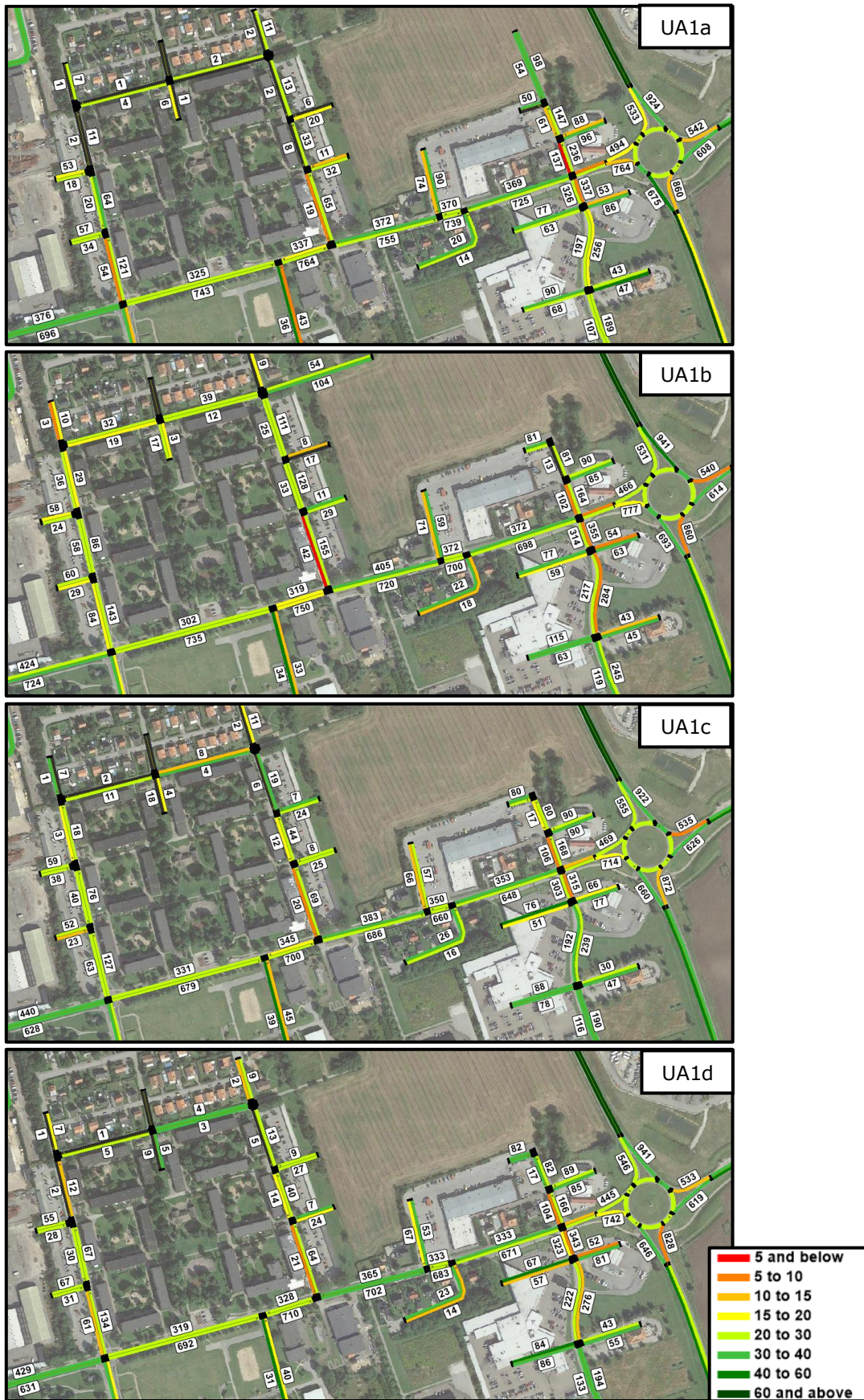
Figur 12. Trafikflöde (siffror på etiketter, fordon/timme) och medelhastighet (färger på länkar) vid Ringsjövägen under eftermiddags maxtimme prognosår 2035. Alternativ med enkel anslutning.
