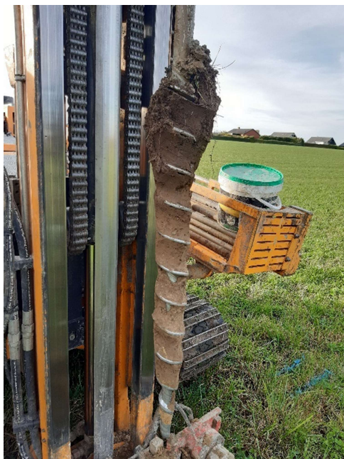
Figur 10. Bilden visar exempel på skruv 0-1 meter under markytan.
