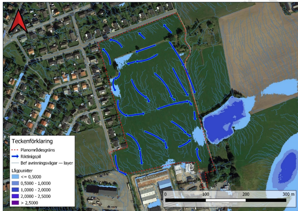
Figur 3. Befintlig ytavrinning och lågpunkter inom planområdet
