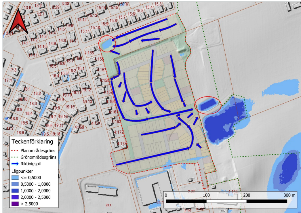
Figur 13. Fördröjningslösningar för Alternativ B.
