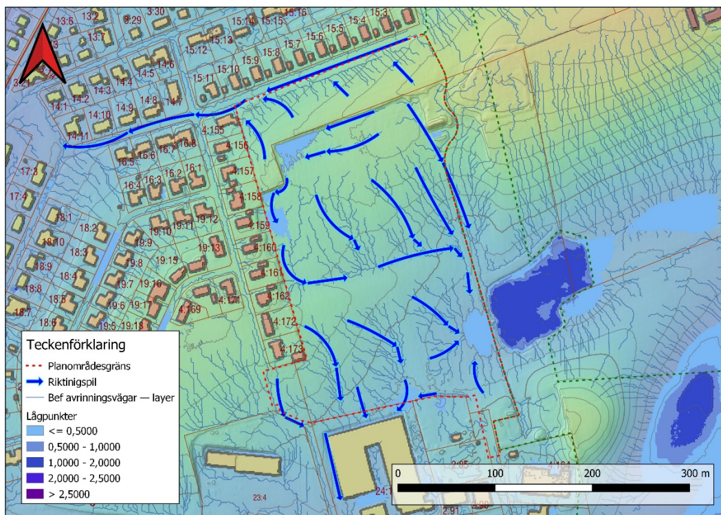
Figur 19. Simulerad ytavrinning vid skyfall för befintliga förhållanden.
