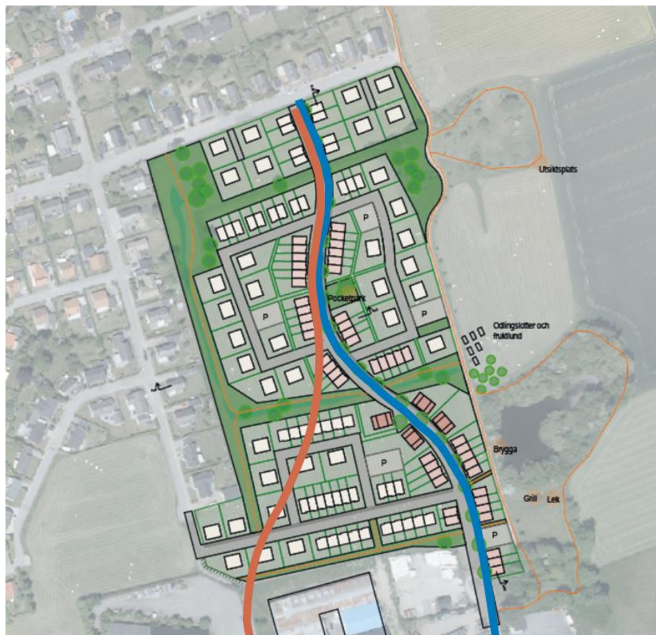
Figur 3-4. Alternativa sträckningar för Bygatan. Blått=nuvarande föreslagen sträckning, orange=alternativ sträckning.
