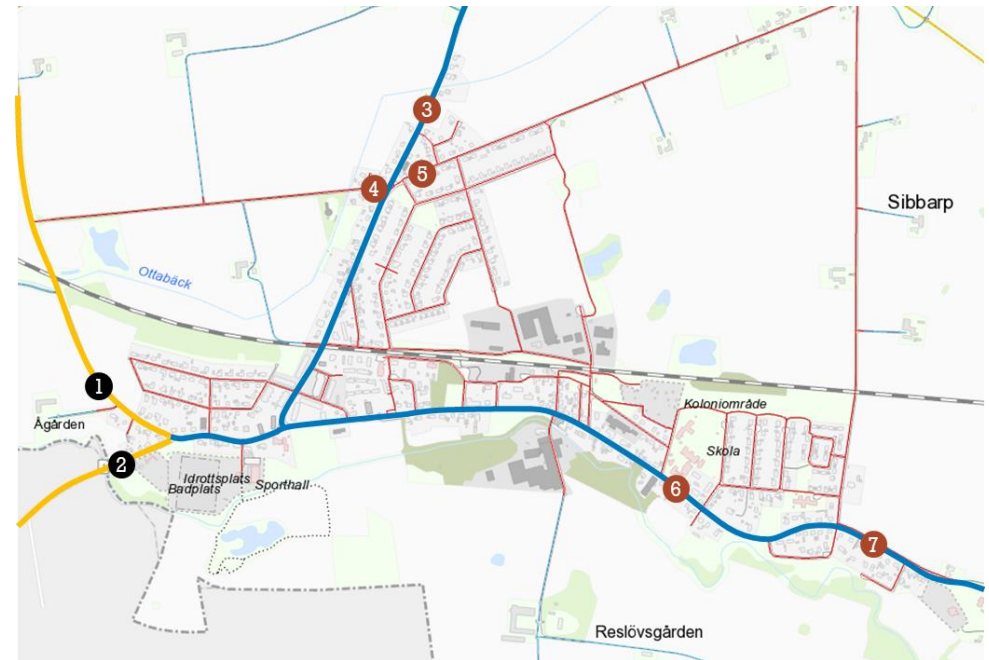
Figur 2-1. Trafikmätningar i Marieholm 2021. Svart = Trafikverkets mätpunkter. Rött = Eslövs kommuns mätpunkter
