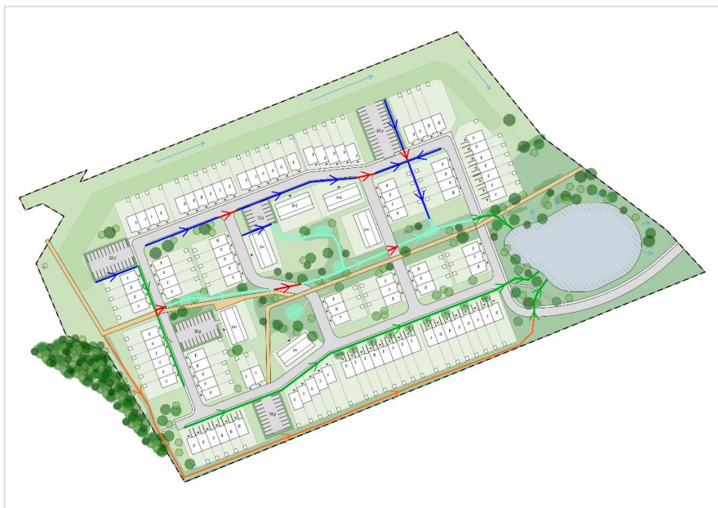
Figur 11: Skiss på förslag till dagvattenlösningar inom planområdet. Blå pil illustrerar dike, röd pil kulvert, turkos pil dagvattenstråk i grönstråk, gröna pilar dagvattenledning, orange pil avskärande dike, mindre nedsänkta ytor i grönstråket visas som turkosa ytor.
