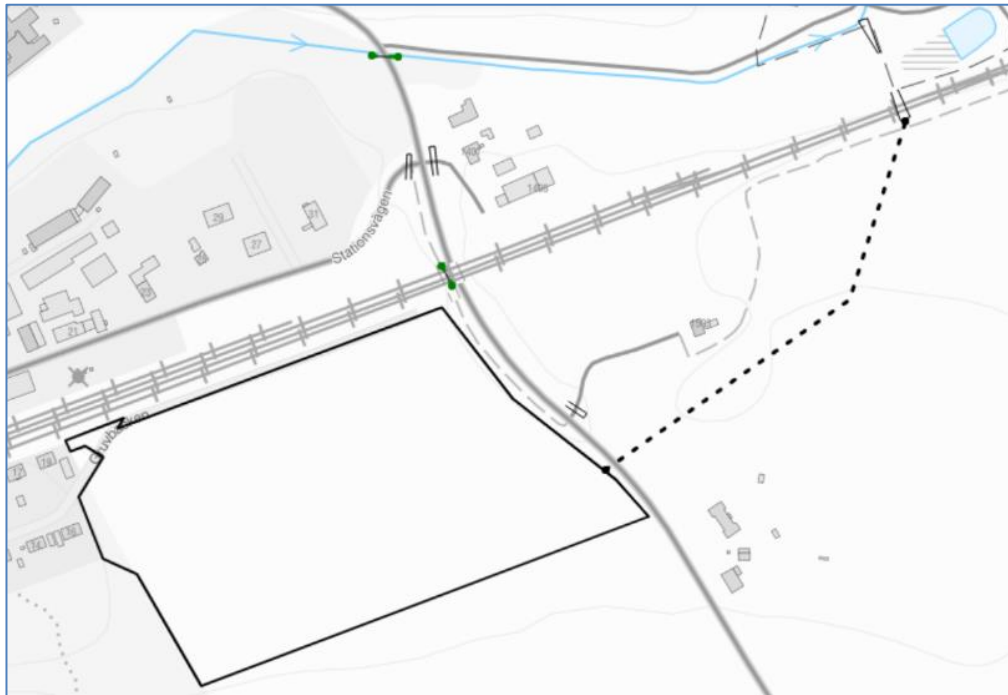
Figur 12: Skiss över ny ledningssträcka för avledning av dagvatten från planområdet som streckad linje. Planområdet visas som svart heldragen linje.
