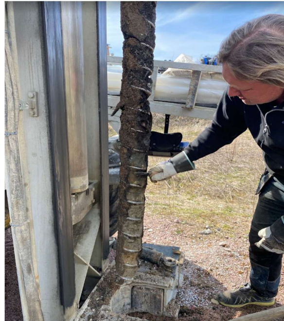
Bild 2. Kontroll av jordlagerföljd
