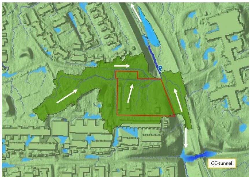
Figur 24. Ansamlingar av vatten vid ett 100-årsregn med 10 minuters varaktighet i dagsläget. Grönt område visar lokalt avrinningsområde till markering (Scalco Live, 2024).
