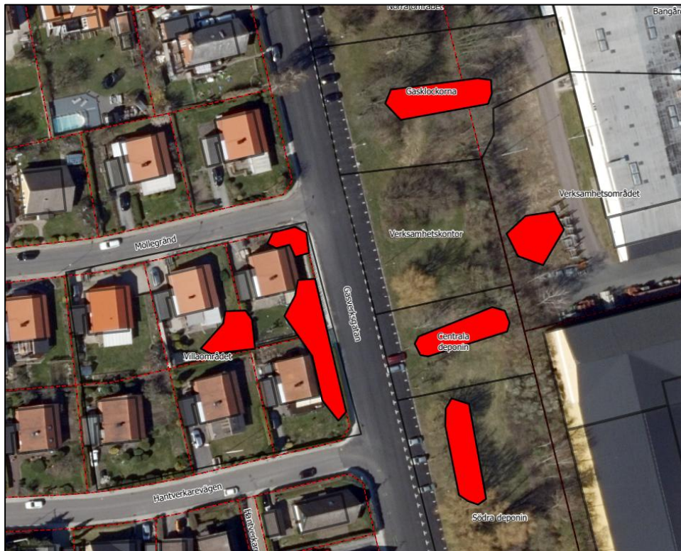
Figur 1. Identifierade källområden med föroreningshalter som i flertalet punkter överskrider gränsvärdet för farligt avfall (FA) inom undersökningsområdet. De svarta linjerna tillsammans med vit text anger de delområden som definierats, beroende på historisk information och föroreningssituation.
