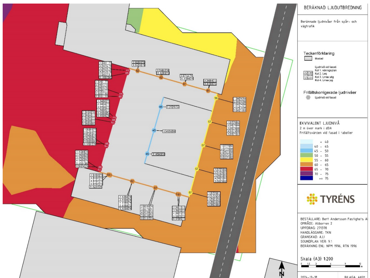
Figur 17. Utsnitt från trafikbullerutredning som visar bullerutbredningen och den ekvivalenta ljudnivån.
